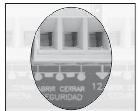
***Si no instala ningún accesorio, se deben puentear los bornes.***
