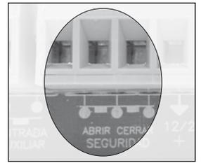
*Si no instala ningún accesorio, debe puentear los bornes.*
