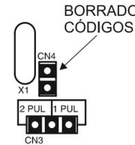
Si comete un error o quiere cambiar el canal de uso, deberá borrar los códigos grabados. Para ello desconecte el equipo de la red, realice un puente entre los contactos de CN4 y vuelva a conectar el equipo a la red. El CR 81/81.8 emitirá un pitido corto y luego sonará de forma continuada. Cuando los códigos estén borrados sonará el pitido de forma intermitente. Retire el puente de CN4 y vuelva a realizar el procedimiento de alta de usuarios.
