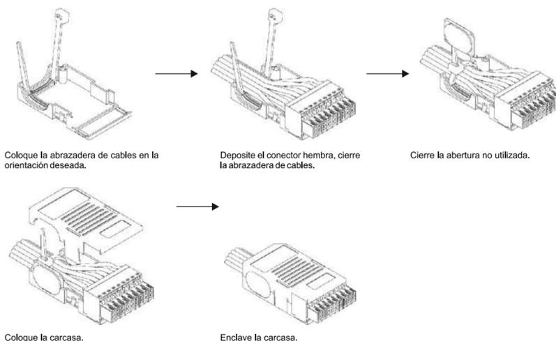
Una vez realizadas todas las conexiones, debe proteger la regleta mediante la carcasa de protección (incluida con el equipo). Para ello siga los pasos indicados a continuación:
